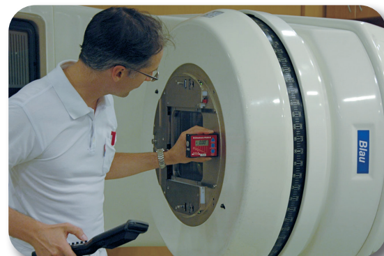
Setting Gantry 90° with CLINOTRONIC Plus Portalwinkel 90° mit CLINOTRONIC Plus setzen
