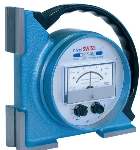
Das nivelSWISS ist ein batteriebetriebener, elektronischer Neigungsmesser mit analoger Anzeige. Die Ablesung erfolgt auf einem eingebauten Galvanometer. Das Gerät verfügt über eine hervorragende Stabilität des Nullpunktes, weshalb dieses speziell für lange dauernde Geometriemessungen und Einstellarbeiten an grossen Führungssystemen geeignet ist.
