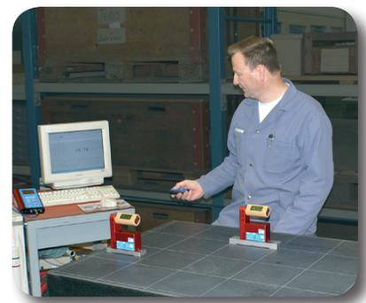
*Ebenheitsmessung mit einem Mess- und einem Referenzgerät*
