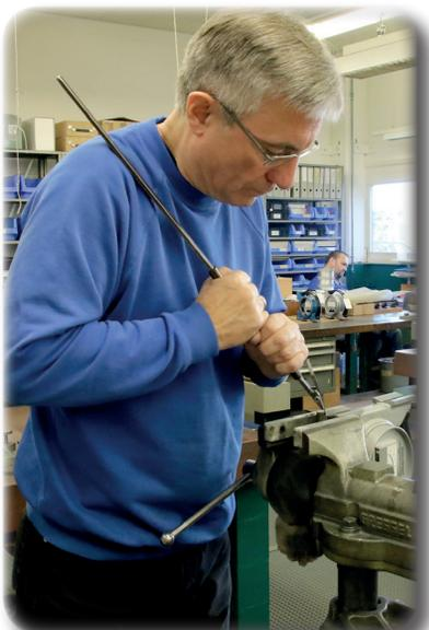
Ein besonderes Merkmal der Präzisions-Wasserwaagen besteht darin, dass die Geometrie aller Messflächen durch Schleifen und manuelles Schaben genau parallel zur Libellenachse einjustiert werden kann. Nur durch diese Präzisionsarbeit ist gewährleistet, dass auch bei einer leicht schräg (Twist) angesetzten Wasserwaage keine Messfehler entstehen.
