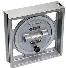
Mit Feineinstellung, mit zwei prismatischen und zwei flachen Messbasen, Teilung von  $2 \times 180^\circ$ , Nonius für Ablesung in 3 Arcmin.
