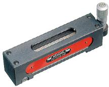
Zum Ausmessen von kleinen Flächen-unebenheiten oder Vertiefungen, Messbereich  $\pm 5$  mm.
