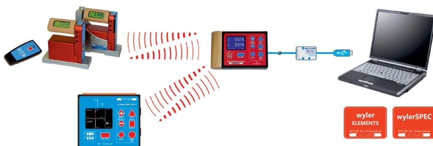
Ein BlueLEVEL-2D und zwei BlueLEVEL über Bluetooth mit einem BlueMETER SIGMA und einem Laptop verbunden. Das BlueMETER SIGMA wird ab dem USB-Port mit Spannung versorgt.
