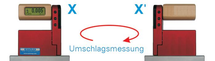
Der absolute Nullpunkt wird automatisch aus einer Umschlagsmessung (zwei Messungen in entgegengesetzter Richtung, jedoch am selben Ort) ermittelt. Man wählt für diesen Vorgang eine geeignete Fläche (starre, unbewegliche Unterlage; möglichst eben und horizontal ausgerichtet), auf welche das Messgerät aufgesetzt wird. Es wird dann je eine Messung in entgegengesetzter Richtung durchgeführt, X und X'.
