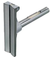
Mit einsteckbarer Rohrwasserwaage, prismatische Messbasis, 150 x 40 mm, für vertikale Messungen, Rohrmessfläche 150 x 10 mm für horizontale Messungen.
