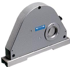
Die kugelgelagerte Pendelscheibe mit Wirbelstromdämpfung richtet sich nach Freigabe der Arretierung schnell nach der Schwerkraft aus. Die Neigung kann bis zur erneuten Freigabe der Arretierung auf der grosszügigen Kreisskala ( $\pm 180$  Grad) mit 10 Min. Nonius abgelesen werden. Präzise geschliffene Messbasis aus gehärtetem Stahl mit eingearbeitetem Prisma.
