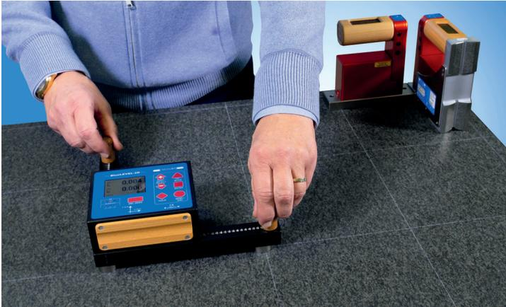
Die Software wylersPEC erlaubt es, die volle Funktionalität des BlueLEVEL-2D auszunutzen: Die Messwerte in X- und Y-Richtung werden gleichzeitig ausgelesen.
