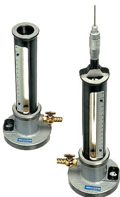
Basierend auf dem Prinzip der kommunizierenden Gefässe, zum Messen von 2 oder mehreren entfernten Punkten, die nicht unmittelbar miteinander verbunden sind, mit Holzetui. Tiefenmikrometer als Zubehör lieferbar.
