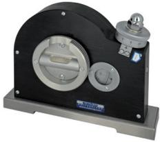
Neigungsmessgerät für genaue Messung jeder Neigung, mit drehbarer Kreisteilung von  $2 \times 180^\circ$ , gehärtete und geschliffene prismatische Messbasis zum Messen auf Wellen und Flächen, Mikrometerskalierung
