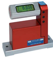
BlueLEVEL mit flacher Messbasis und Handgriff aus Aluminium für die Anwendung in Clean-Räumen
